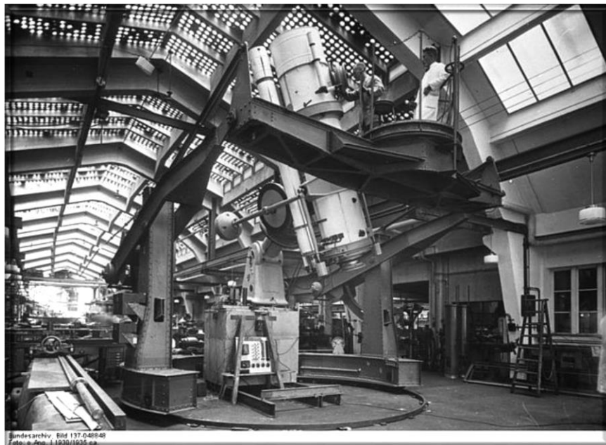
1934年紫金山天文臺建臺時從德國蔡司公司(Carl Zeiss AG)購置的600毫米反射望遠鏡，附石英分光鏡與觀測升降台，這是當時中國以至遠東口徑最大的天文望遠鏡。
