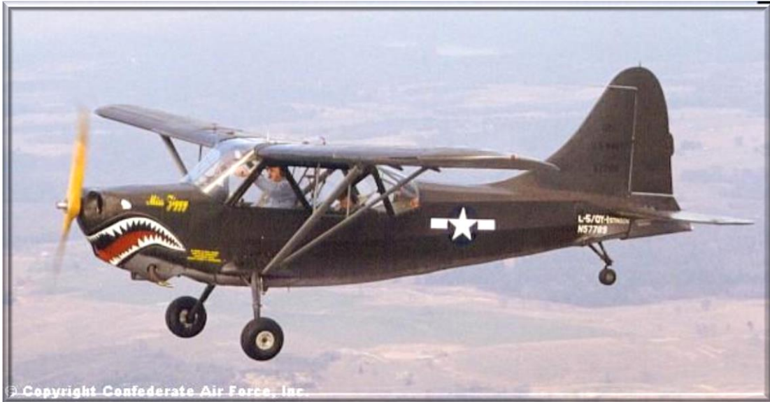
史汀森 L-5 通訊飛機 (聯絡飛機) / 飛行速度：每小時 144 公里 / 最高時速：每小時 209 公里 The Stinson L-5 Sentinel was a World War II era liaison aircraft purpose-built for military use by all branches of the U.S. military.
